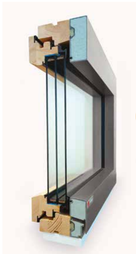
Moderní okenní profil s trojsklem kombinuje dřevěnou nosnou část s odolnou vnější vrstvou. Vícekomorová konstrukce zlepšuje tepelněizolační vlastnosti okna
